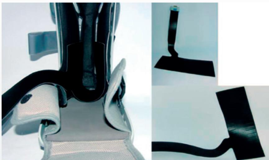
Abbildung 1: Setup aus Walker Orthese und medilogic Druckmessmatte
