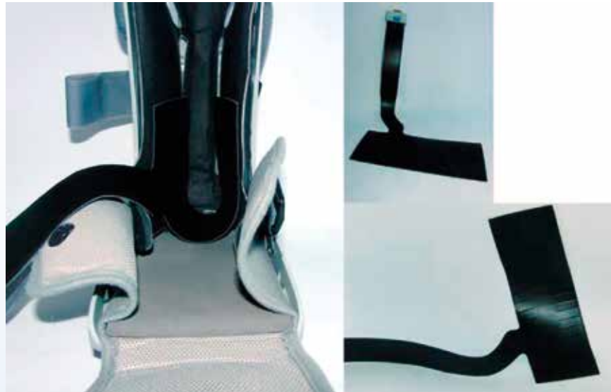
Abbildung 1: Setup aus Walker Orthese und medilogic Druckmessmatte
