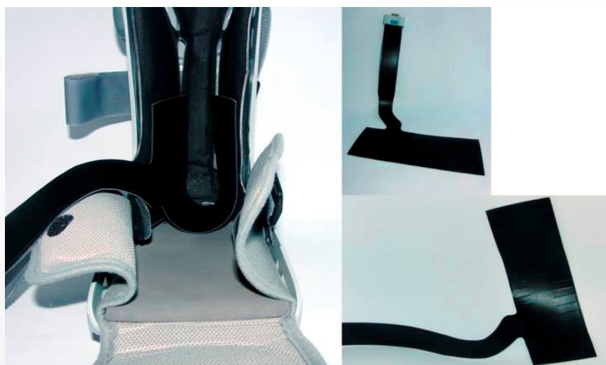
Abbildung 1: Setup aus Walker Orthese und medilogic Druckmessmatte
