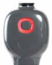
Geschwindigkeit der Führung des Applikators zu niedrig
