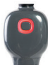
Geschwindigkeit der Führung des Applikators zu niedrig
