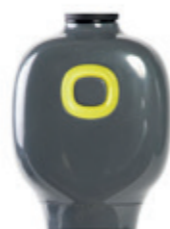
Geschwindigkeit der Führung des Applikators zu hoch
